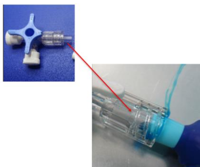
Afbeelding 1: Mogelijke lekkageplaats bij de behuizing van de driewegkraan
